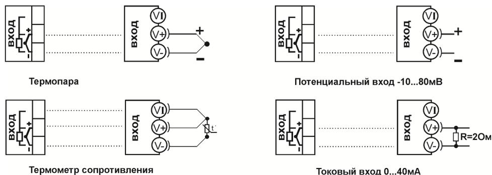
Рисунок 7 – Схемы подключения датчиков
